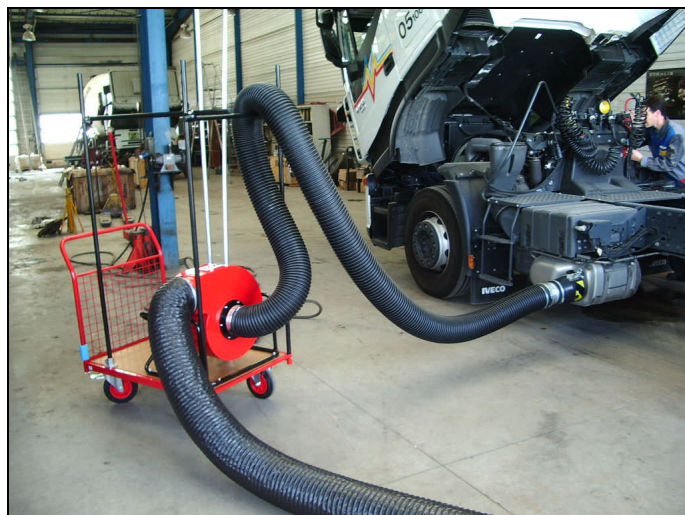
Avec option chariot mobile : Pour déplacer facilement le ventilateur et les flexibles
